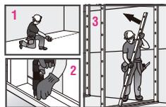
**Paso 2:** Coloque las placas en forma vertical, horizontal o trabadas según diseño, una al lado de la otra, dejando una separación entre ellas de 6mm (junta visible). Asimismo, deje una separación de 1cm desde el piso hacia la parte inferior de la placa y desde el fondo de losa hacia la parte superior de la placa, así como en los lados laterales del tabique de encontrarse con un muro o estructura de un sistema constructivo diferente.
